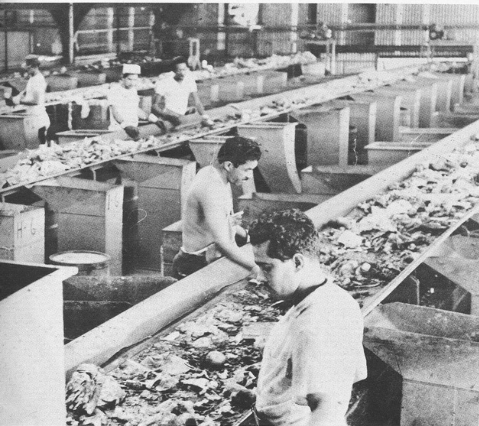
He aquí la planta seleccionadora, primera fase de todo un complejo industrial. Un electroimán separa metales y latas.
